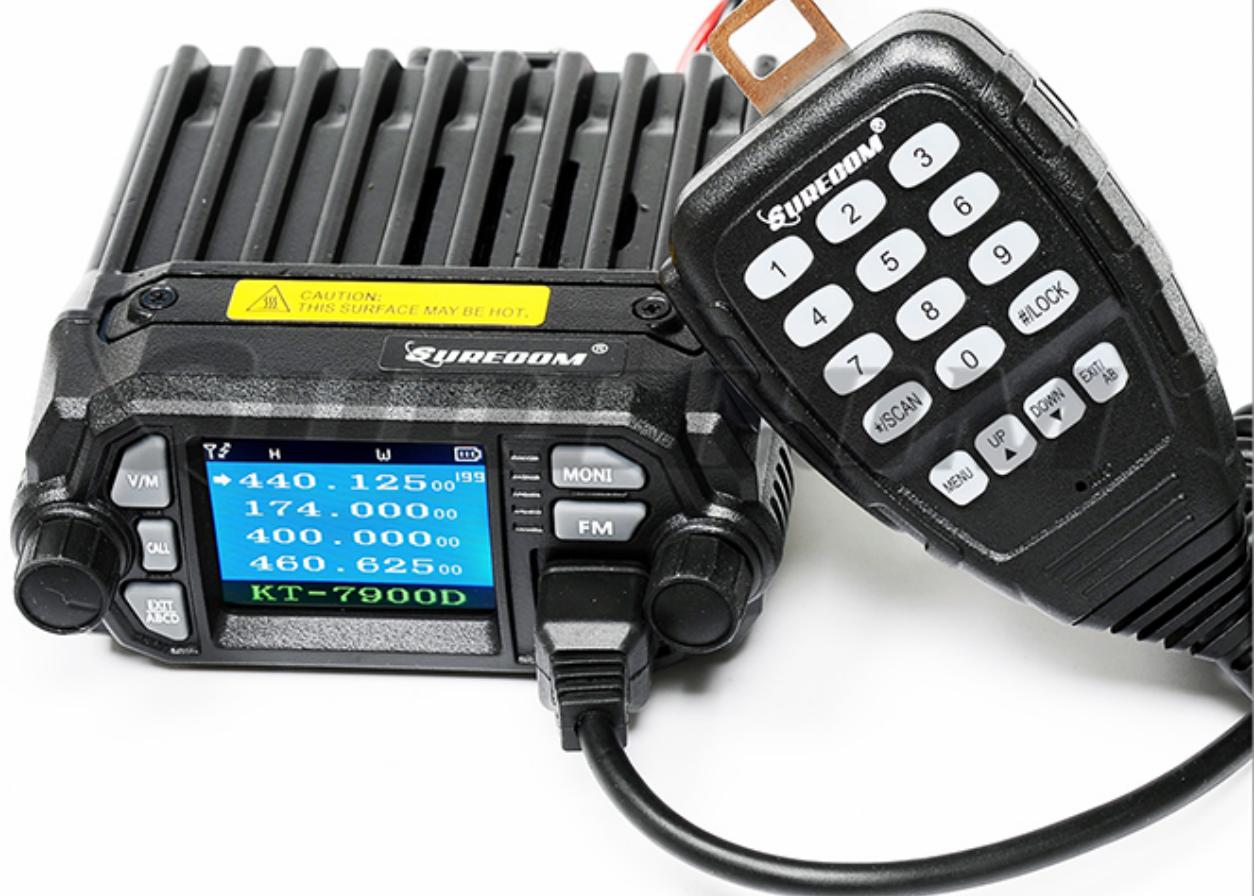
Sono state previste due possibilità di collegamento verso RTX a basso costo ( baofeng uv82L e KT-7900D) ; nel caso del KT-7900D il circuito trae la sua alimentazione direttamente dal RTX tramite lo stesso cavo UTP5 che porta i segnali audio e PTT.
